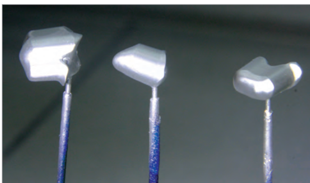
Abb. 6: Nach dem Aufbringen des Silberleitlacks ist die glatte, homogene Oberfläche gut erkennbar – Vorstufe für die Galvanokrone.
