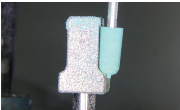
Abb. 2: Kontrolle des 2-Grad-Winkels und Abziehen des Abrasivkörpers zur Oberflächenbearbeitung mithilfe eines Zurichtsteins.
